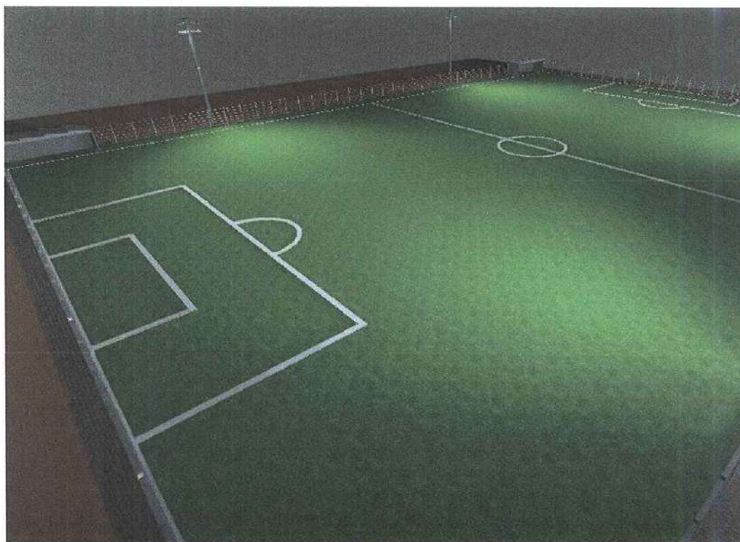
Figura 6 – Simulação no software DIALux Evo durante a noite
